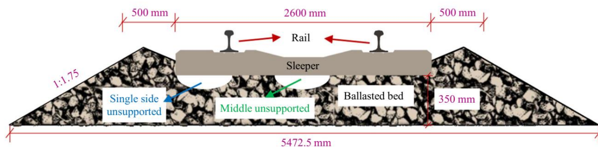
شکل (۲)- نمای جانبی خط بالاستی با وجود نشست در وسط و یک طرف خط (Liu et al., 2023)
