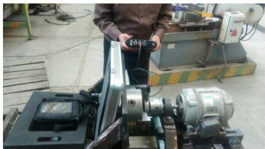
شکل (۴). نحوه قرارگیری پروپ حسگر VT60 بر روی بدنه بیرینگ
