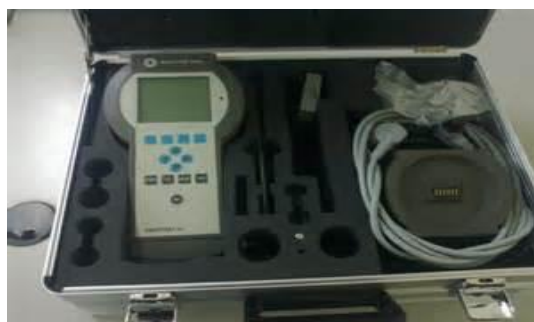
شکل (۳). دستگاه VT60 برای اندازه گیری ارتعاش
