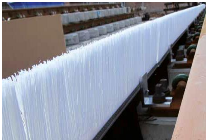
شکل (۱۶). چیدمان و کارایی برس جهت دهنده مسیر باد
