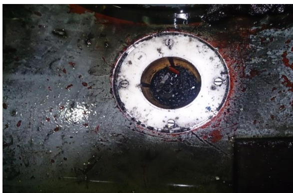
شکل (۶). منافذ برگشت نشتی روغن به مخزن در تاج پرس
