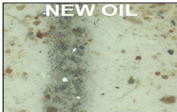
شکل (۴). آلودگی های موجود در روغن تازه
