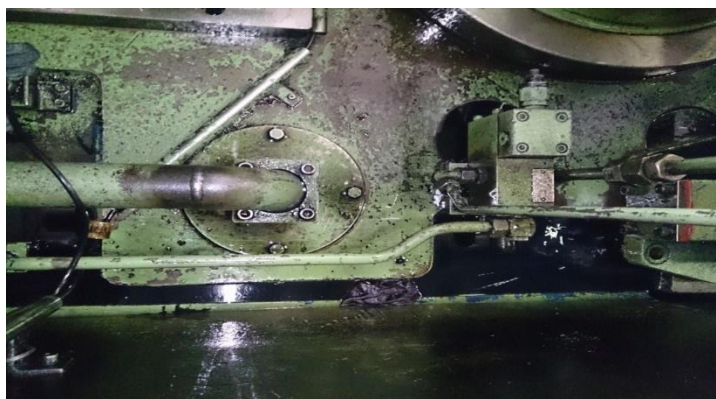
شکل ۵: آلودگی موجود در تاج پرس
