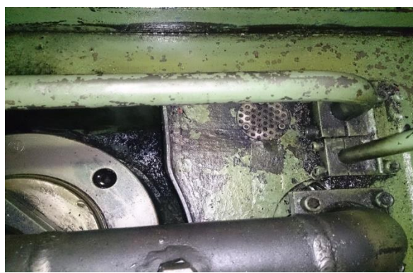
شکل (۶). منافذ برگشت نشتی روغن به مخزن در تاج پرس
