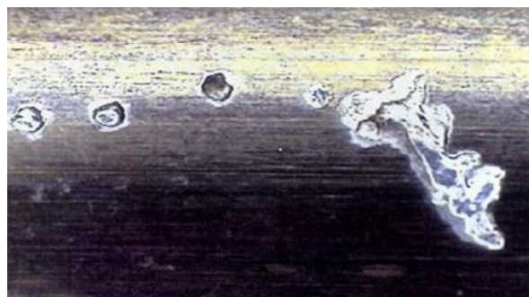
شکل (۱). تصویری میکروسکوپی از حفره‌زایی ناشی از جریان الکتریسیته روی سطح یاتاقان بابیت دار
