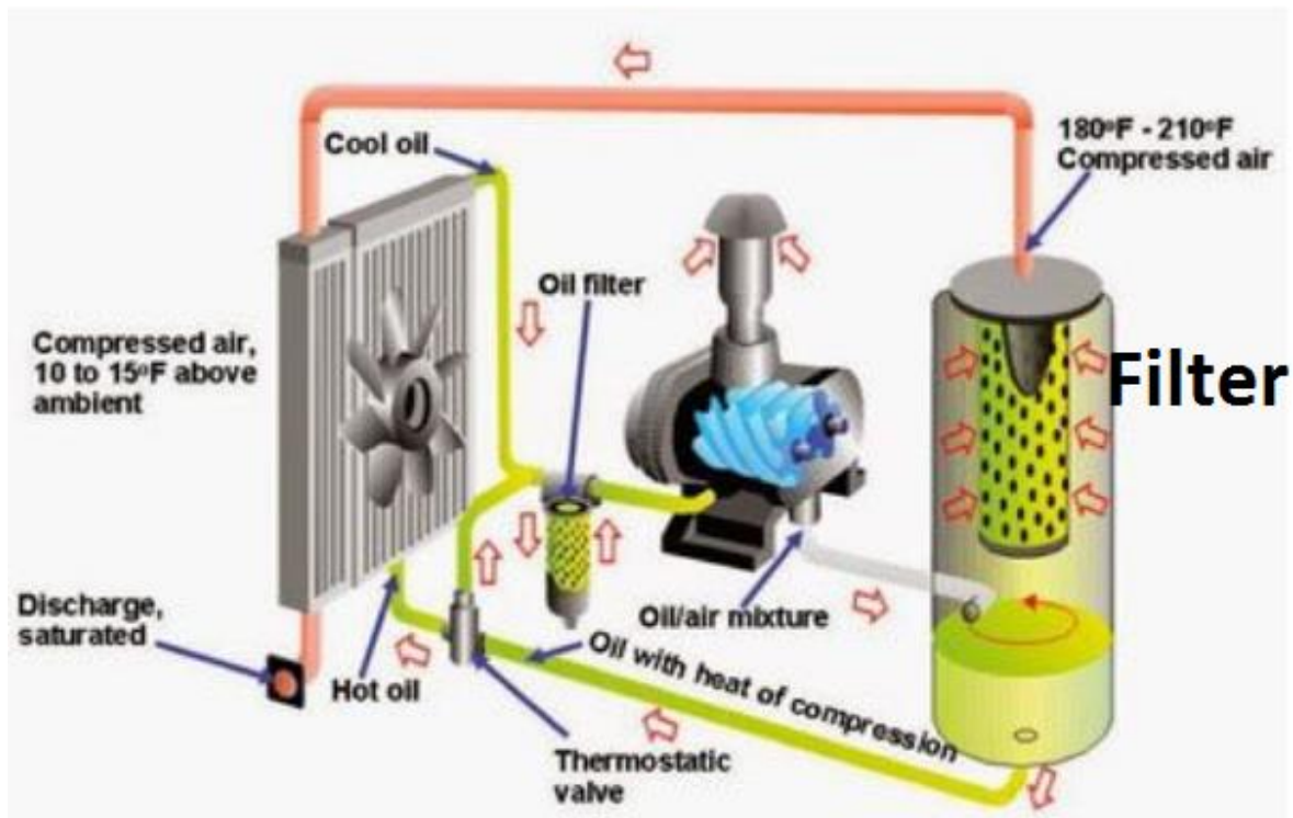
شکل (۳). مدار چرخش روغن و تولید الکتریسیته در فیلتر
