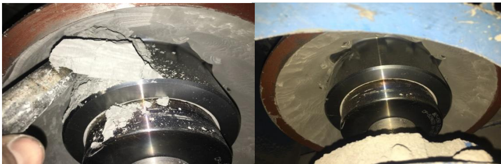
شکل (۷). فاین های انباشته شده در قسمت های داخلی باند ۱۲
