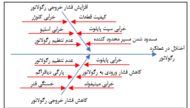
شکل (۷). اختلال در عملکرد رگولاتور
